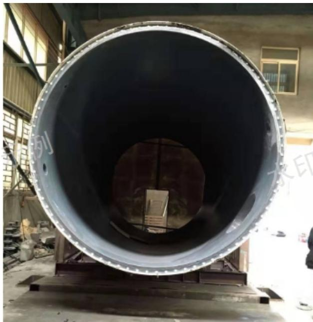
滚涂工艺，目前在国内外应用，它不受设备本身的形状，复杂的结构，能一次性无缝，无痕的成型，选用的材料可以根据介质温度及使用放入工作状况来确定，目前本公司的滚涂设备可以生产3.3米以内的防腐设备及管道件。本公司的衬塑设备采用先进的热旋转工艺和进口高性能原料，根据用户的不同使用要求，选用合理的配方及比较好的衬里厚度，将塑料与钢基体热熔结合。其特点是钢材与塑料成为一体，结合力强，可同步膨胀收缩，不易脱层，衬里层还具有无搭接缝，无气泡，无，耐冲击强度高，抗渗透性能好，表面平整光亮似搪瓷，摩擦系数小，不易结垢等特点。任何结构形状设备，管道，管件均可加工。目前主要采用的塑料有ETFE(F-40)及PO辽宁滚衬ETFE。就选无锡市伟业化工防腐设备厂，有需求可以来电咨询！
